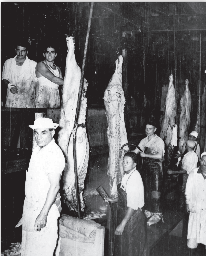
Trabajo en playa de faena: operaciones de emprolijamiento ("dressing"), lavado y secado (nótese los trapos utilizados al efecto), previos al sellado de las medias canales.
